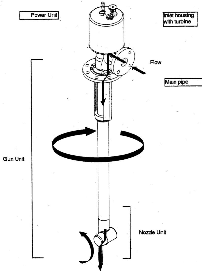
Fig. 3 - Programmable Jet Washer (courtesy Toftejorg Ab)
