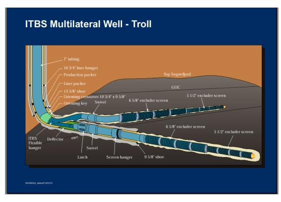
Figure 2. ITBS<sup>™</sup> Installation
