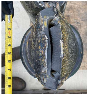
8.5" OD Tool Joint 64ppf, V150
