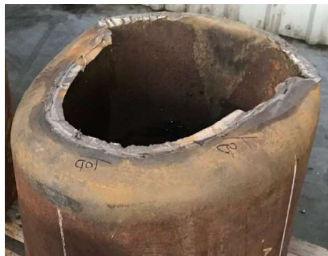
18" OD Casing Q125 117ppf 6-5/8" OD Inner String V150, 50ppf
